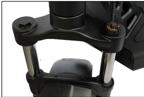
Die Federgabel lässt sich mit einer Einstellschraube (Abb. 1.) justieren, welche sich auf der rechten Seite unten an der Federgabel befindet. So wird die Federung (gegen den Uhrzeigersinn) weicher oder (im Uhrzeigersinn) härter.
